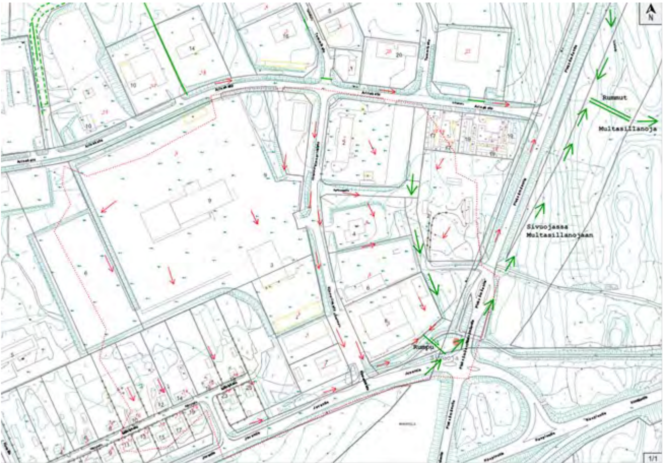
Kuva 2, oleva hulevesiverkosto koostuu avo-ojista, purkusuunnat kuvattu nuolilla.
